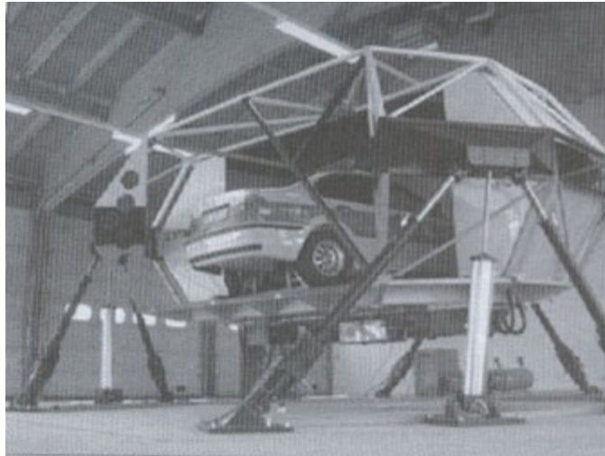
能够进行车辆替换和低 profile 6-DoF 运动平台的 RDE 警车驾驶模拟器
